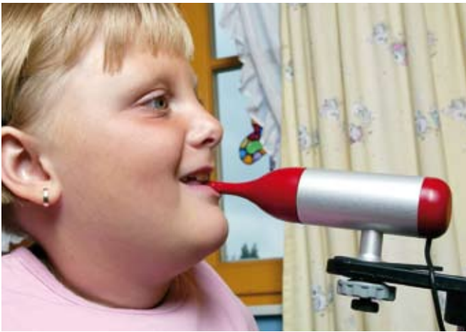
Mit minimalen Bewegungen der Lippen lässt sich der Cursor der IntegraMouse bewegen
