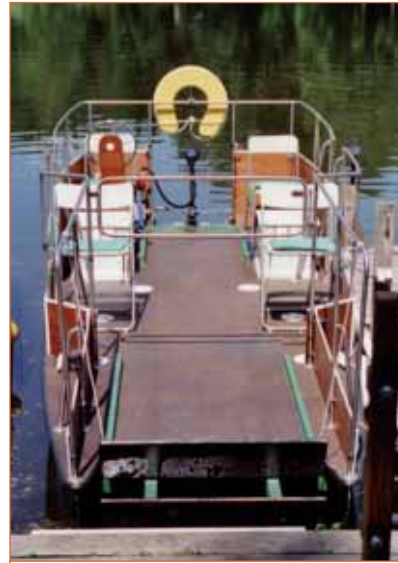
Dieser Katamaran auf der Talsperre Kriebstein ist über eine Bugrampe für Rollstuhlfahrer leicht befahrbar.
