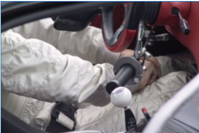
Blick in das Cockpit des Rennautos. Deutlich erkennbar das Handgas. Mit weißem Knauf die Schaltung, die über eine Saug-Blas-Schlauch ausgelöst wird.
