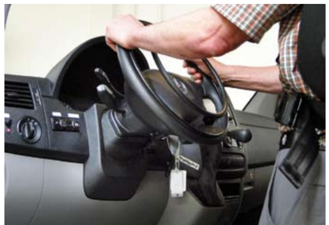
Gas und Bremse werden per Hand bedient.
