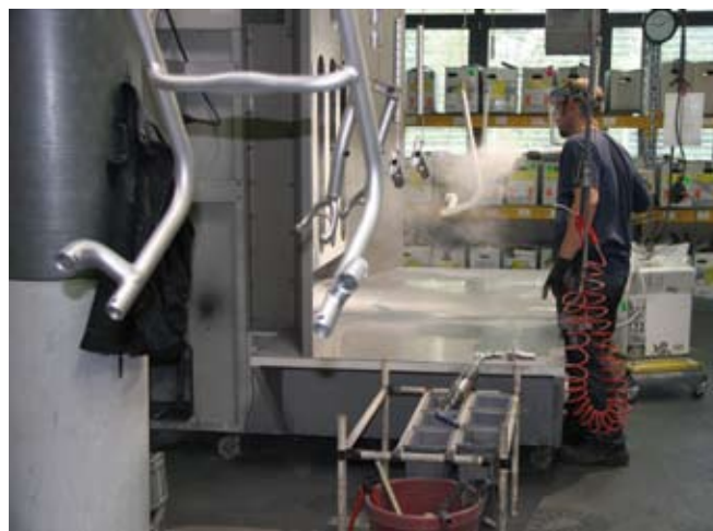
Nicht nur technisch muss der moderne Rollstuhl dem späteren Nutzer passen. Das äußere Erscheinungsbild ist mit kaufentscheidend. Im Bild: die Pulverbeschichtung in individuellen Farben.
